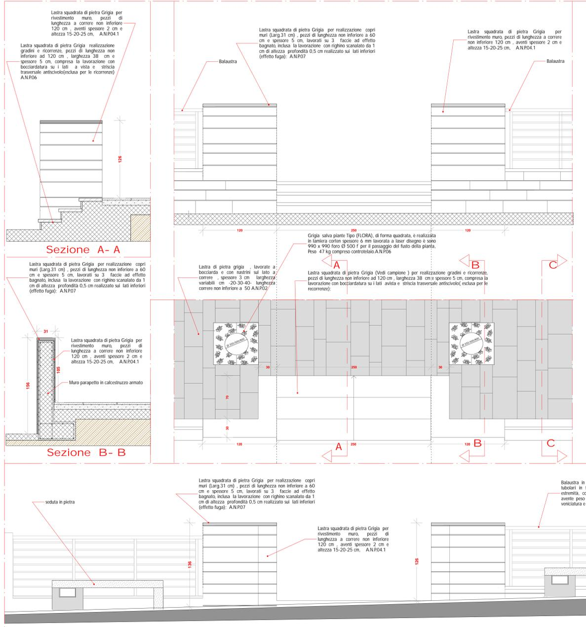
**PARTICOLARE 4 : Pianta, Sezioni e Prospetti di dettaglio scala di accesso campo di pallavolo, parapetto e balaustra scala 1:20**
